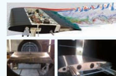
Figure 1. en haut : Interaction fluide-structure autour du prototype en morphing bio-inspiré de l'aile A320 : modification de la structure tourbillonnaire du sillage
